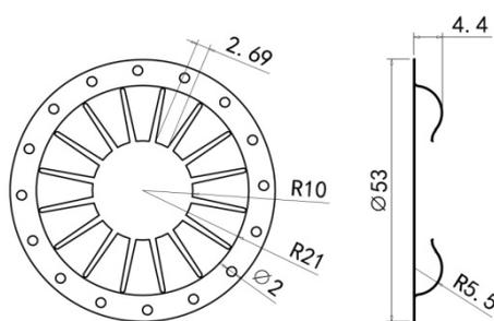
镀铜材料厚度: T=0.2MM, 主要用于缝隙填充和导电.
