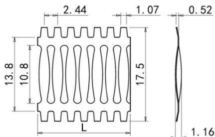
镀铜材料厚度: T=0.15MM, L=610MM (根料) 或 L=7.62 米卷料. 用于缝隙填充和导电, 表面镀银.
