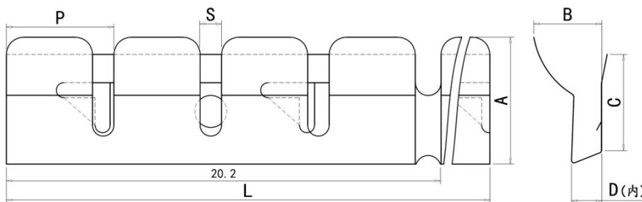
材料: 不锈钢材料 SUS301-1/2H, T=0.1mm
