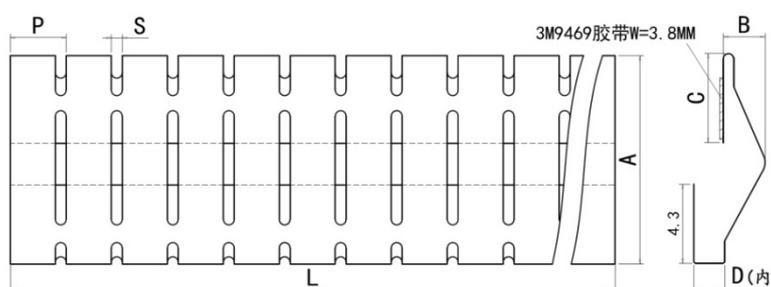
材料: 不锈钢材料 SUS301-1/2H, T=0.08mm
