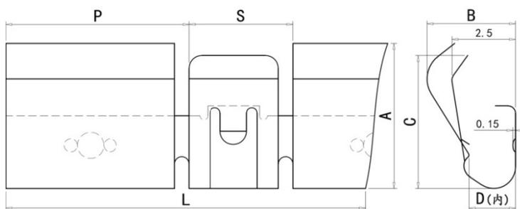
材料: 不锈钢材料 SUS301-1/2H, T=0.08mm
