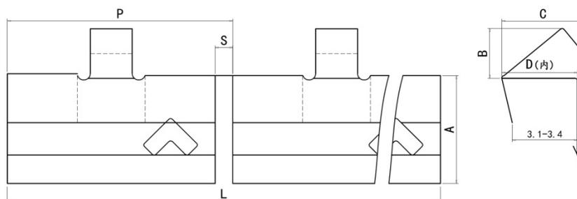
材料: 不锈钢材料 SUS301-1/2H, T=0.1mm
