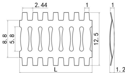
镀铜材料厚度: T=0.15MM, L=610MM (根料) 或 L=7.62 米卷料. 用于缝隙填充和导电, 表面镀银.
